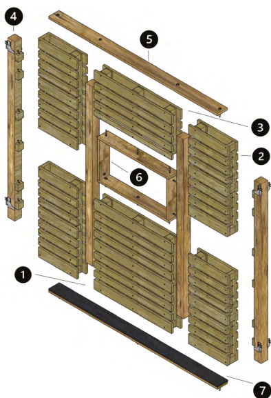
Figura 1. Los componentes del sistema de muros B-Pallets
