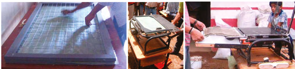
Figura 4. Proceso de elaboración de teja de microconcreto
