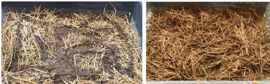
Figura 5. Mezclado de la pajarcilla
