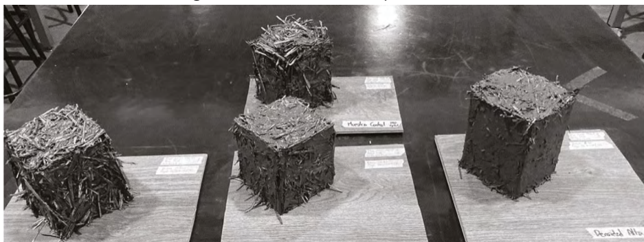
Figura 6. Muestreo de mezclas por densidad
