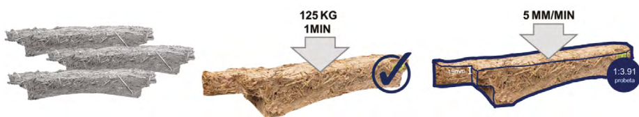
Figura 10. Numero de probetas para evaluación de pieza y condiciones de prueba
