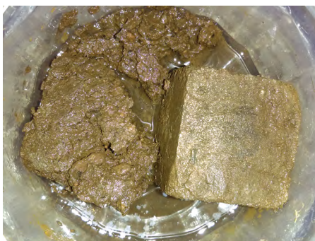
Figura 15. Izquierda cubo de arcilla natural, derecha cubo de arcilla estabilizada con cal después de una semana sumergida en agua
