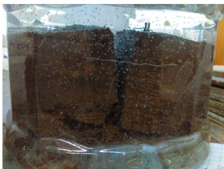
Figura 14. Izquierda cubo de arcilla natural, derecha cubo de arcilla estabilizada con cal sumergidos en agua
