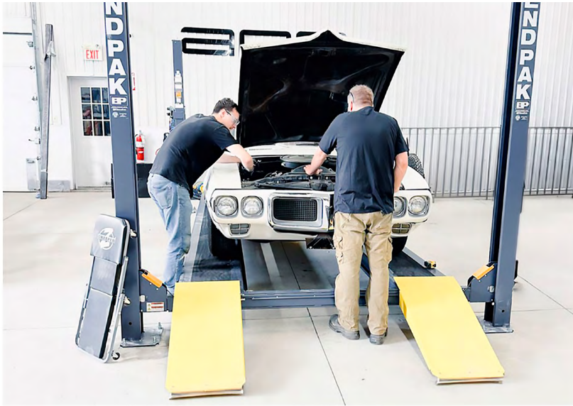
Figura 19.4. Auto clásico siendo convertido en eléctrico
