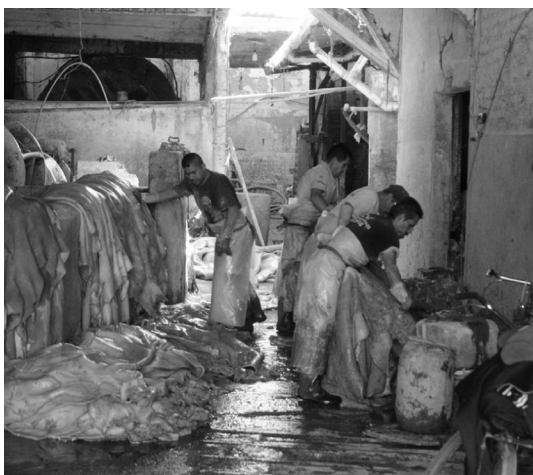
Figura 6.4. Tenería en el Barrio Arriba. Nótese los tambores de madera y los trabajadores descarnando la piel a la derecha
