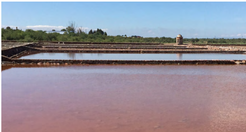
Figura 8.6. Piletas cristalizadoras, nótese el color rosado de la salmuera
