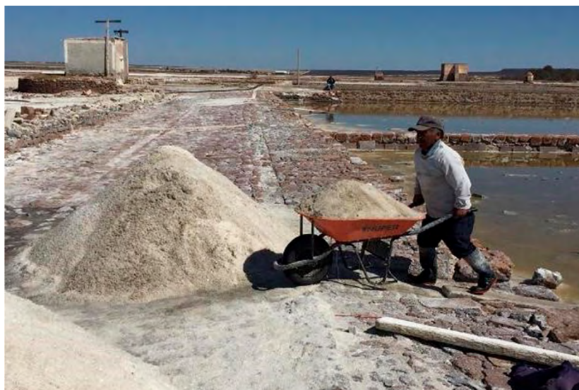
Figura 8.8. Acarreo de sal a la asoleadura mediante carretilla con perforaciones
