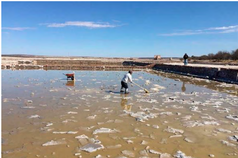
Figura 8.7. Barrido de sal mediante escoba de zacate
