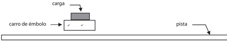
**Demostración 2:** Los dos carros con pistones están inicialmente en reposo sobre la vía. Los émbolos de los carros están completamente bloqueados y los dos carros se colocan uno contra el otro como se muestra en la figura 3.18. Prediga las velocidades relativas del carro cuando los émbolos se sueltan.
