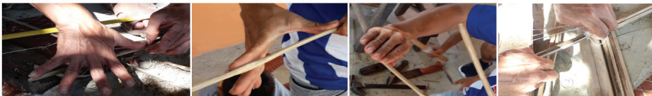
FIGURA 9. Uso de la pita, el metro y la regla para verificar medidas
