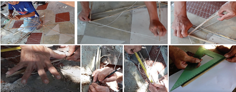
FIGURA 9. Uso de la pita, el metro y la regla para verificar medidas
