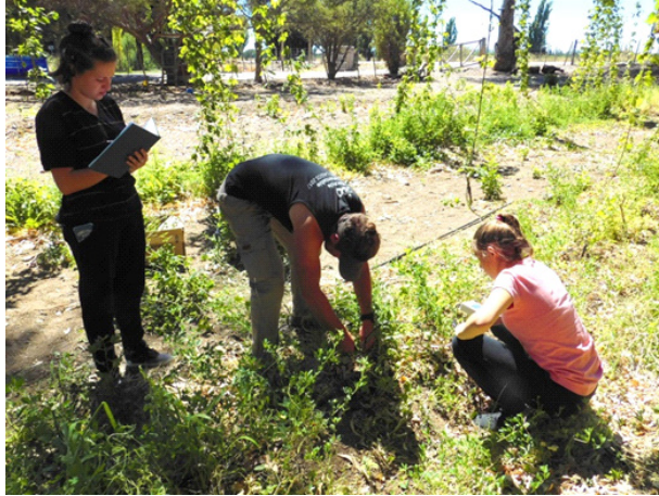
FIGURA 2. Medición de humedad de suelo con sondas ECH 2 O
