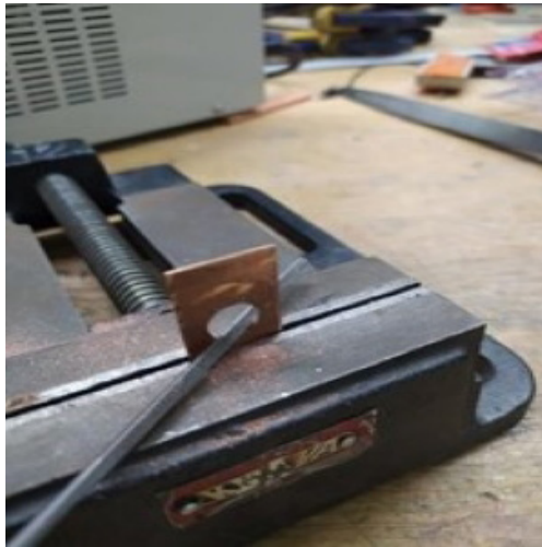
Figura 10. Proceso de limado del orificio de la placa de cobre utilizada para construir el conector
