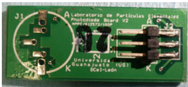
Figura 2. Tarjeta-F manufacturado, vista en la cara inferior con conector 3-pin header
