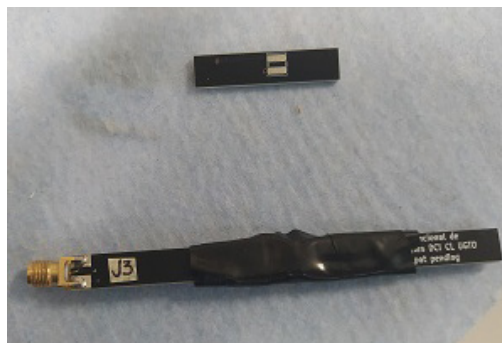
Figura 7. Fotografía del fotomultiplicador montado en la tarjeta electrónica con un conector SMA para la recolección de información
