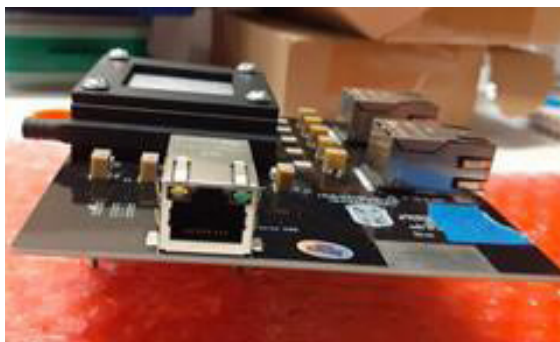
Figura 10. Vista lateral de la cámara de gas montada en la tarjeta electrónica
