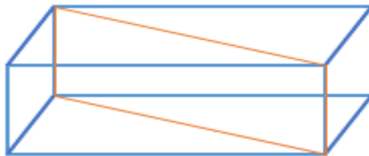
Figura 7. Usando alambre sería posible crear el rectángulo cuya diagonal se puede medir directamente con la regla
