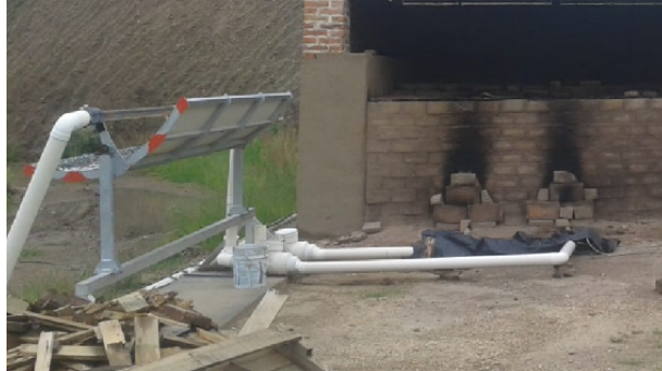
Figura 8. Sistema de inyección de aire caliente
