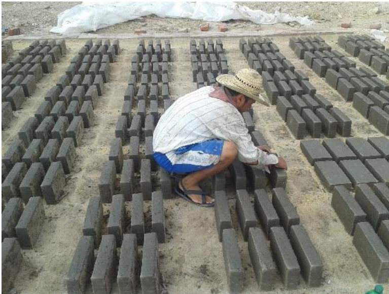
Figura 1. Proceso manual de fabricación de ladrillo rojo
