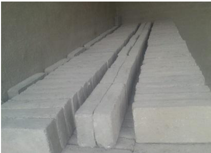
Figura 9. Acomodo del ladrillo. (a) Venteos transversales. (b) Venturis
