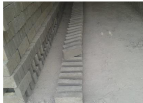
Figura 9. Acomodo del ladrillo. (a) Venteos transversales. (b) Venturis
