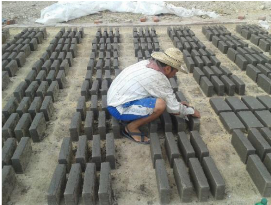
Figura 1. Proceso manual de fabricación de ladrillo rojo
