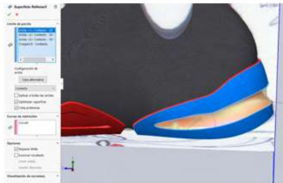
Figura 8.37. Rellenar por superficie
