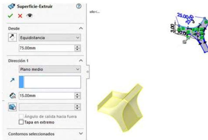
Figura 6.7. Extruir por superficie
