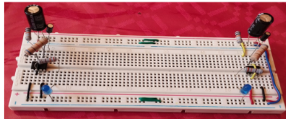
Figura 6. Construcción circuito LM555
