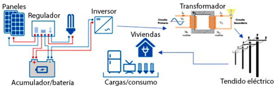
Figura 2. Diagrama de la granja solar
