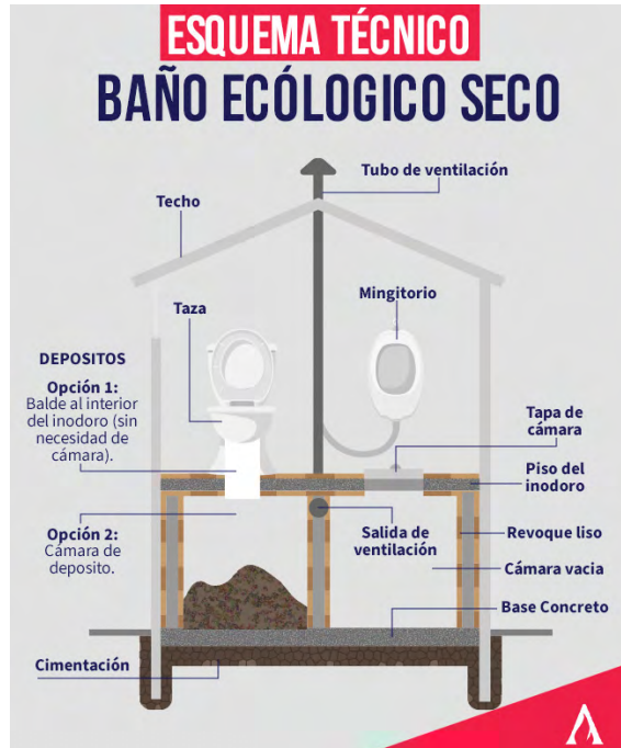
Imagen 1. Esquema técnico de baño ecológico seco
