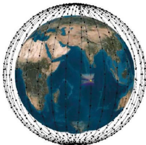
Figura 20. Configuración de la constelación para el sistema OneWeb. [76]
