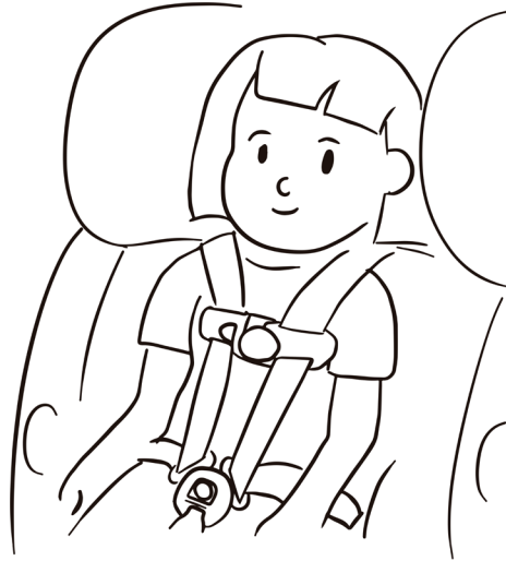
Figura 5. SRI con arnés de cinco puntos
