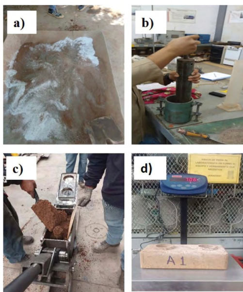
Figura 2. a) Mezcla del suelos con estabilizantes, b) prueba de compactación dinámica estándar, c) elaboración de BTC con la máquina CETA-RAM II y d) bloque de tierra comprimida con suelo de
