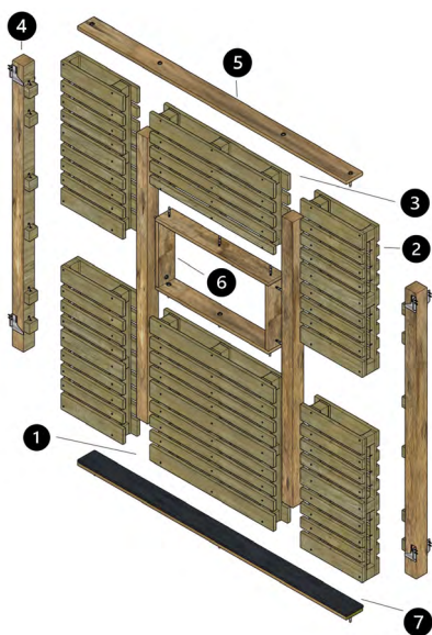
Figura 1. Los componentes del sistema de muros B-Pallets
