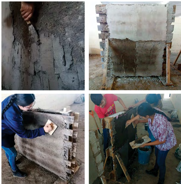
Figura 6. Pruebas de proporcionamiento para revocos de tierra y cal. Taller vivencial con estudiantes de arquitectura de la Universidad Veracruzana, Región Veracruz
