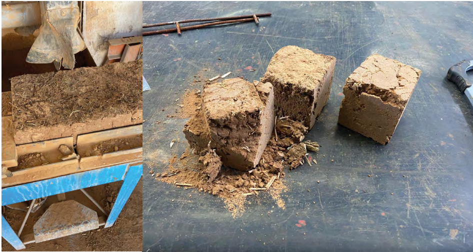
Figura 3. Labrado de especímenes de los adobes ensayados
