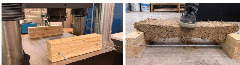
Figura 9. Soporte para pruebas a piezas
