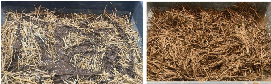
Figura 5. Mezclado de la pajarcilla
