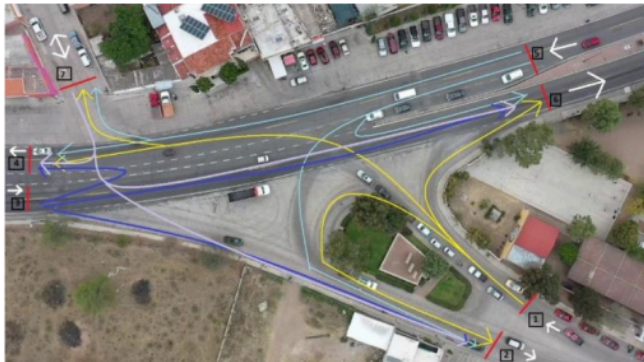
Figura 3. Detección del flujo vehicular (origen y destino) y conteo de vehículos
