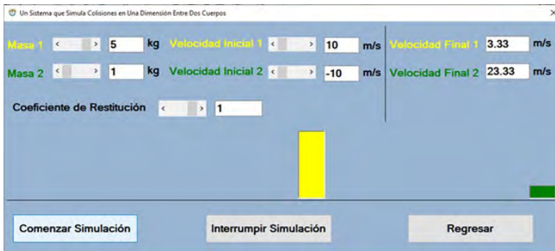
Figura 3.13. Ventana que muestra el resultado de la colisión cuando uno de los cuerpos tiene una masa cinco veces mayor que la otra y se mueven con velocidades opuestas
