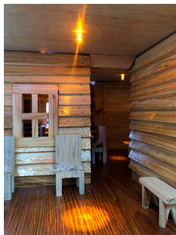
Figura 16.7. Sistema de iluminación funcionando en el prototipo
