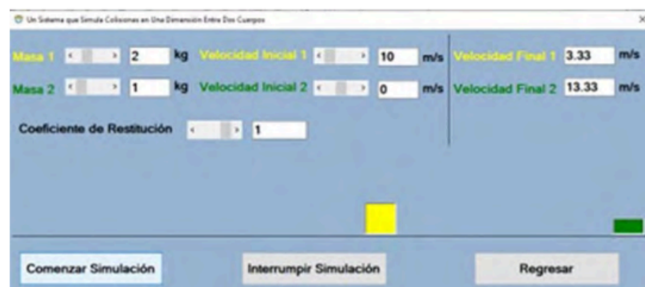
Figura 3.5. Ventana que muestra el resultado de la colisión cuando una masa es el doble de la otra
