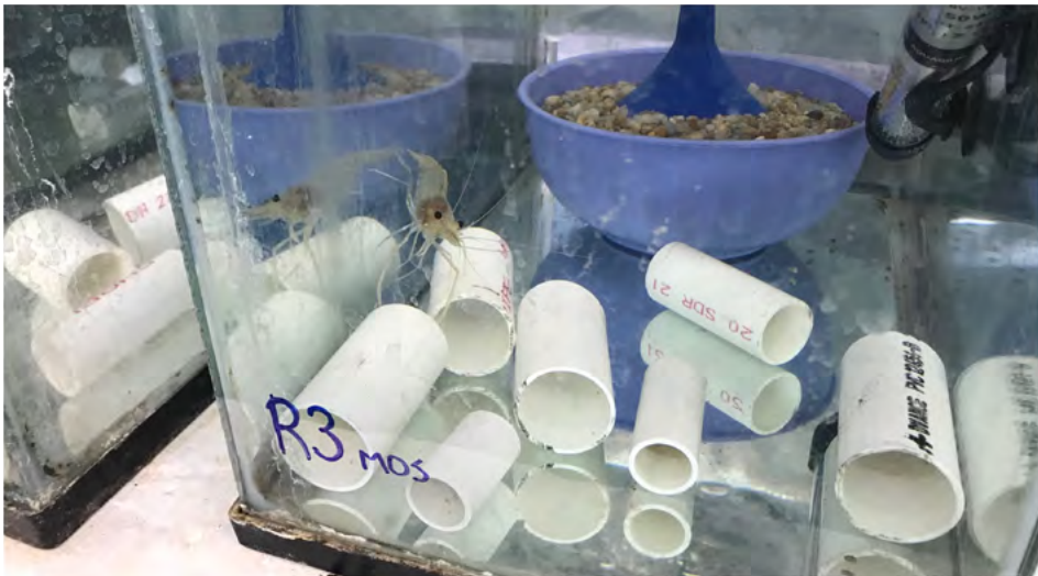
Figura 5. Estructuras de resguardo (tubos de PVC) en un tanque con langostinos y que permiten disminuir la agresión de organismos dominantes durante una prueba de alimentación
