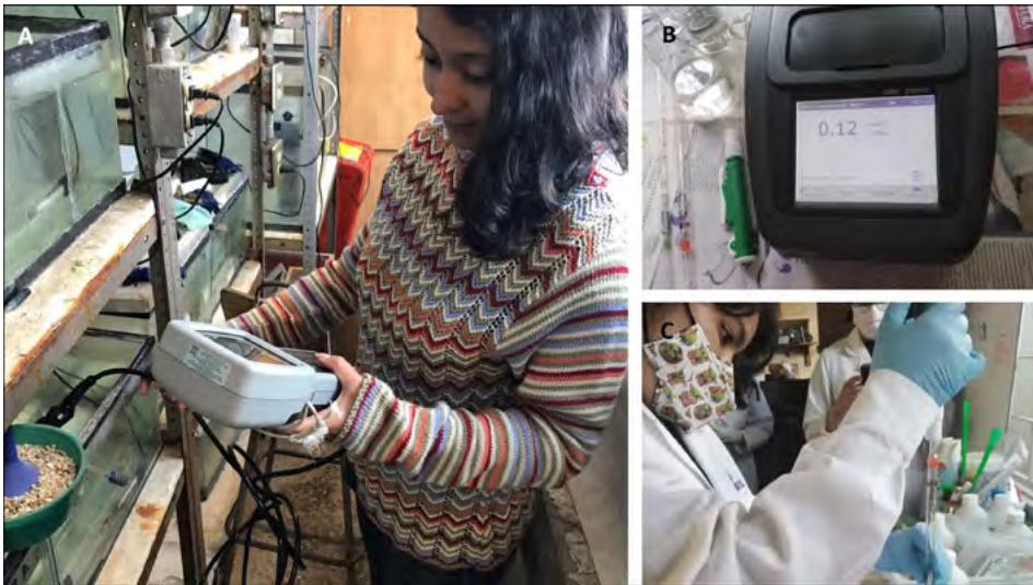
Figura 3. Aspectos de la determinación de parámetros fisicoquímicos del agua para monitorear la calidad del agua durante pruebas de alimentación
