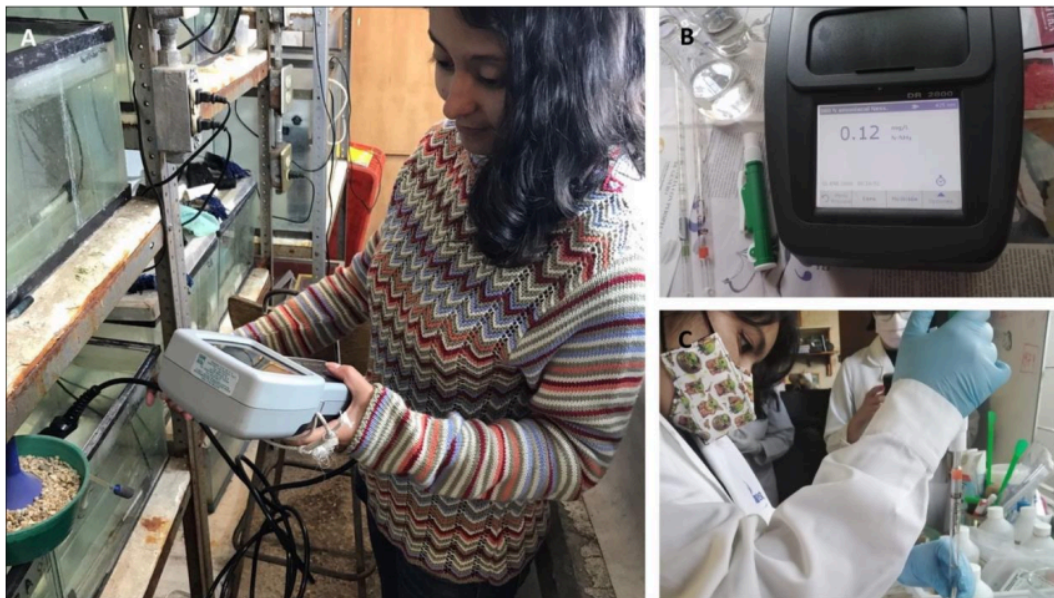
Figura 3. Aspectos de la determinación de parámetros fisicoquímicos del agua para monitorear la calidad del agua durante pruebas de alimentación: A , determinación de oxígeno disuelto y temperatura en una pecera con langostinos. B y C , determinaciones de nitrógeno amoniacal.
