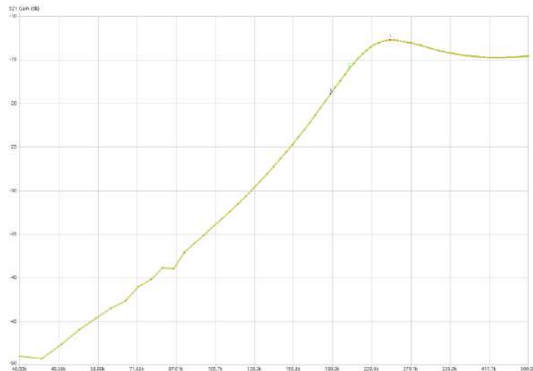
Figura 5.35. Respuesta obtenida del circuito en NanoVNA Saver. Ejercicio 2.4
