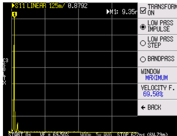
Figura 5.3. Configuración de trazo para determinar longitud del coaxial
