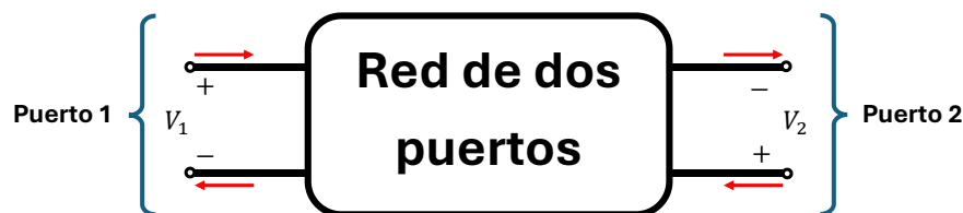
Figura 3.6. Red de dos puertos para parámetros S
