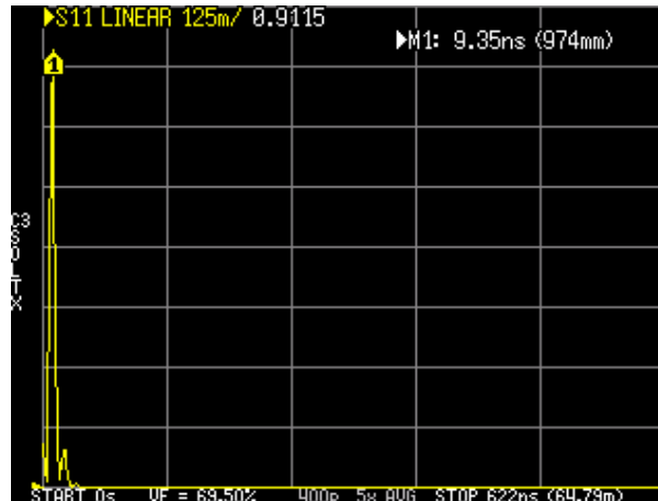
Figura 5.4. Determinación de longitud del coaxial
