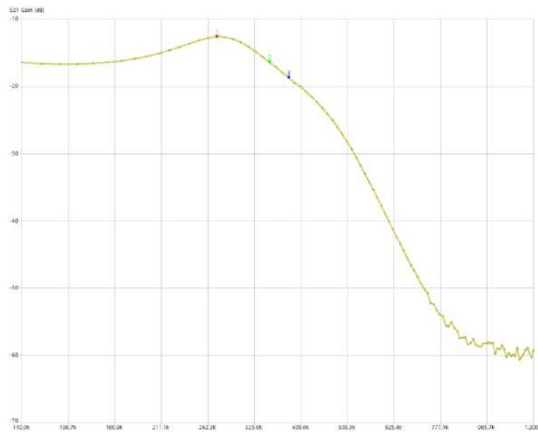
Figura 5.28. Respuesta obtenida del circuito en NanoVNA Saver. Ejercicio 2.3
