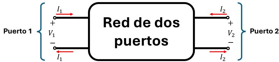
Figura 3.1. Red de dos puertos con sentidos de referencia para voltaje y corriente
