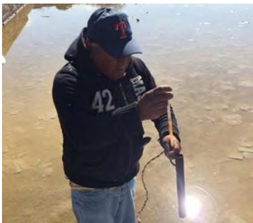
Figura 8.4. Salinero midiendo la salinidad de la salmuera mediante un densímetro salinómetro
