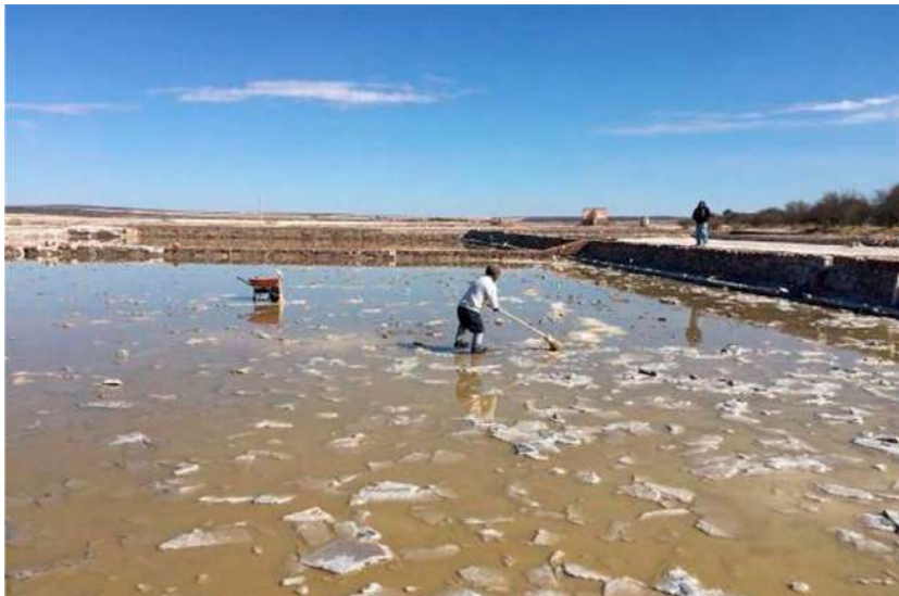
Figura 8.7. Barrido de sal mediante escoba de zacate
