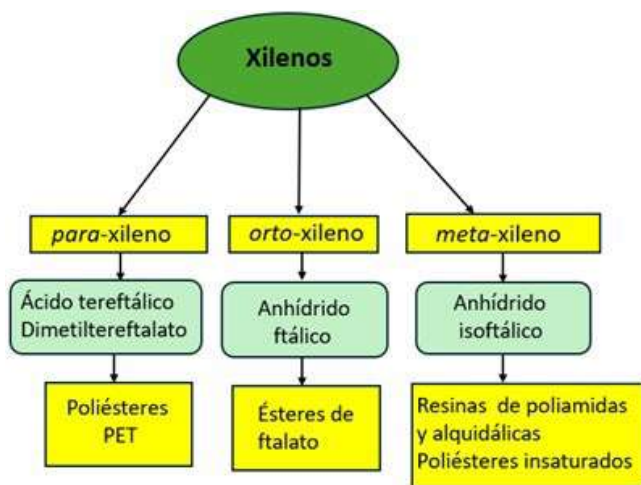
Figura 4.10. Principales productos que pueden obtenerse a partir de los xilenos
