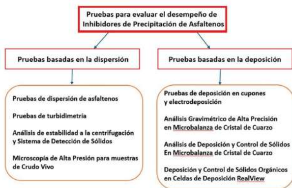
Figura 7.6. Métodos de selección de inhibidores de asfaltenos
