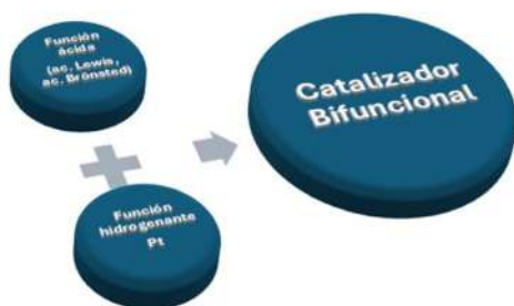
Figura 3.5. Composición del catalizador de isomerización
