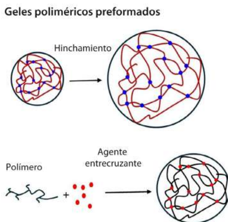
Figura 8.15. Esquema de algunas clases de geles utilizadas para el control de agua en pozos
