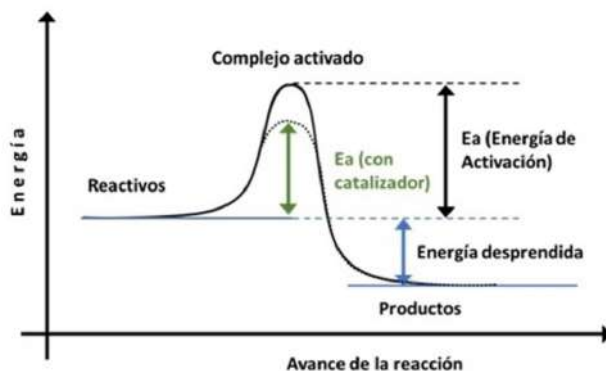
Figura 3.1. Efecto del catalizador en la energía de activación
